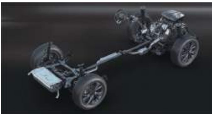
Передняя подвеска: макферсон, задняя подвеска: многорычажная независимая + полный привод
